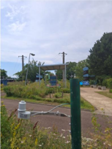
Pluviomètre installé dans le Jardin des énergies
